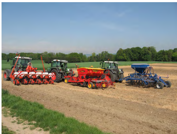
Abb. 1: Einzelkornsägerät, Scheiben-Drillmaschine und Sägrubber
